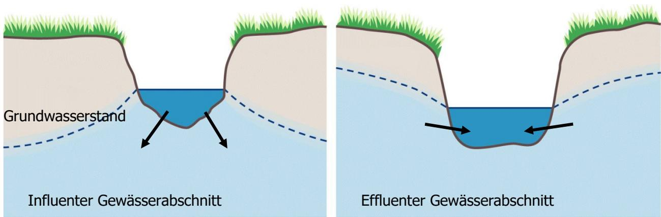
**Abbildung 1: Darstellung von influenten und effluenten Gewässerabschnitten<sup>3</sup>**
