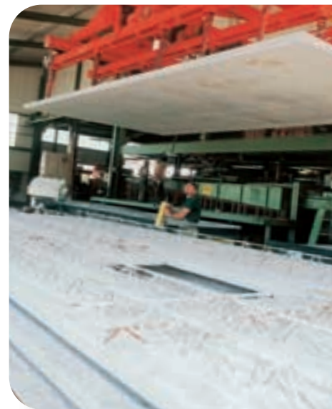
HERTWECK BAUELEMENTE Betondecken-Fertigung
