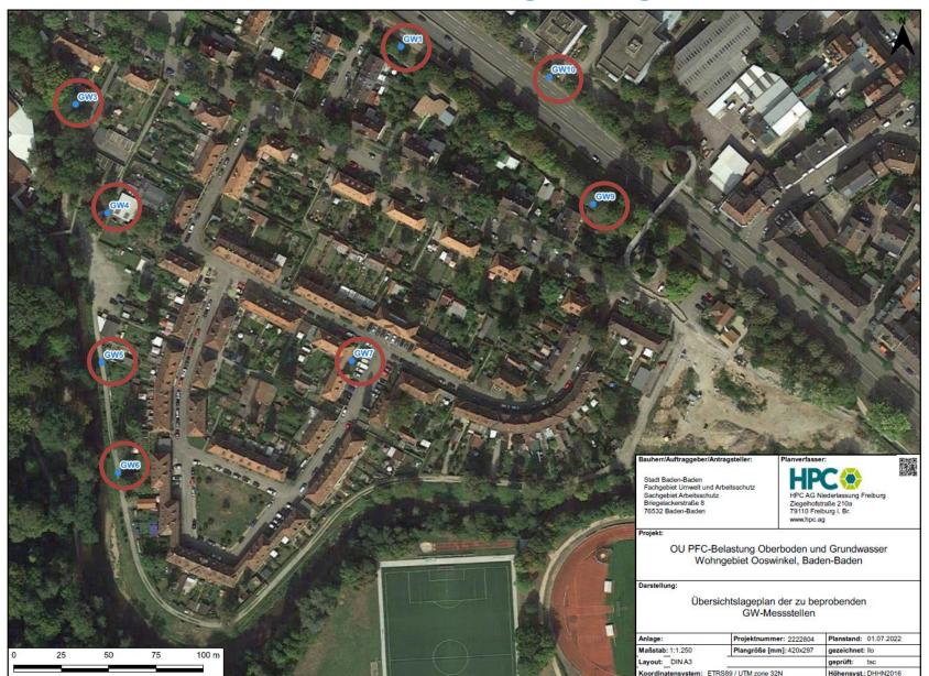
Grundwasserbeprobung an bestehenden GW-Messstellen im Bereich Ooswinkel mit Laboranalysen auf PFC
