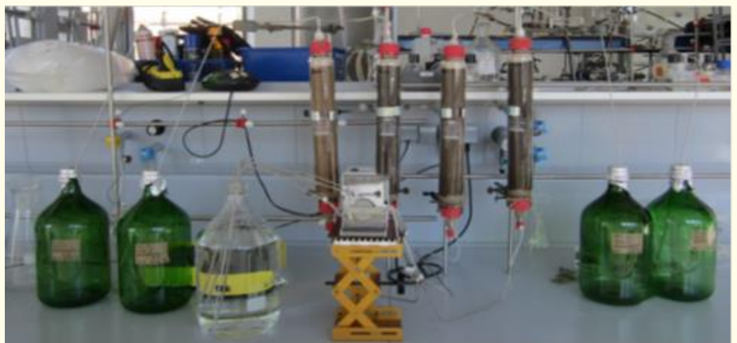
Aufbau eines Säulenperkolationsverfahrens im Labor [Quelle: TZW: DVGW-Technologiezentrum Wasser]
