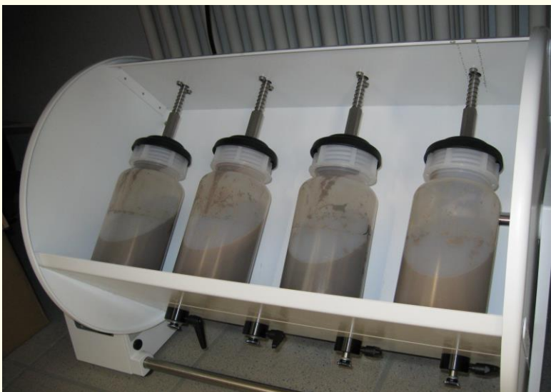
Überkopfschüttler, welcher für das Schüttelverfahren verwendet wird [Quelle: TZW: DVGW-Technologiezentrum Wasser]
